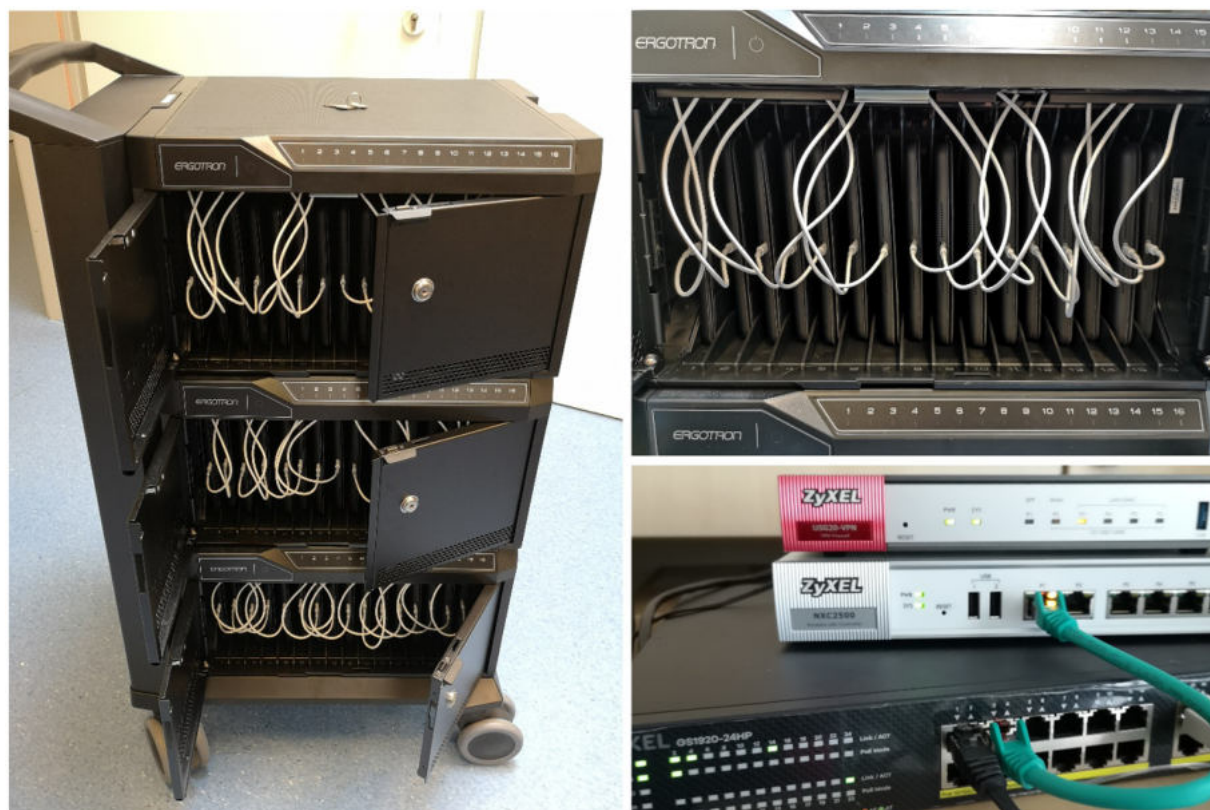
Abbildung 1: Portable Wagen (iPads) zur Lagerung und Administration der Prüfungsgeräte (links, rechts oben) sowie portabler Switch, WAP-Controller und VPN-Firewall für den WLAN-Aufbau (rechts unten)
